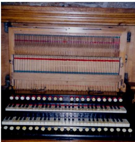
Fig. 4. – Le sommier vertical du deuxième clavier avec sa mécanique après dépose de la boîte expressive [2].
