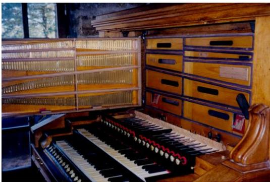
Fig. 3. – Vue de l'instrument après ouverture du sommier vertical du deuxième clavier [2].
