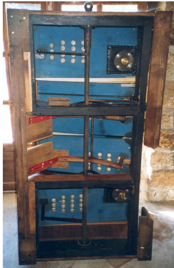
Fig. 5. – La soufflerie avec ses quatre soufflets [2].
