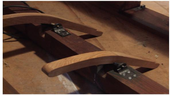
Fig. 6. – Leviers des pédales reconstitués à l'identique en bois de hêtre et montés sur leurs crapaudines
