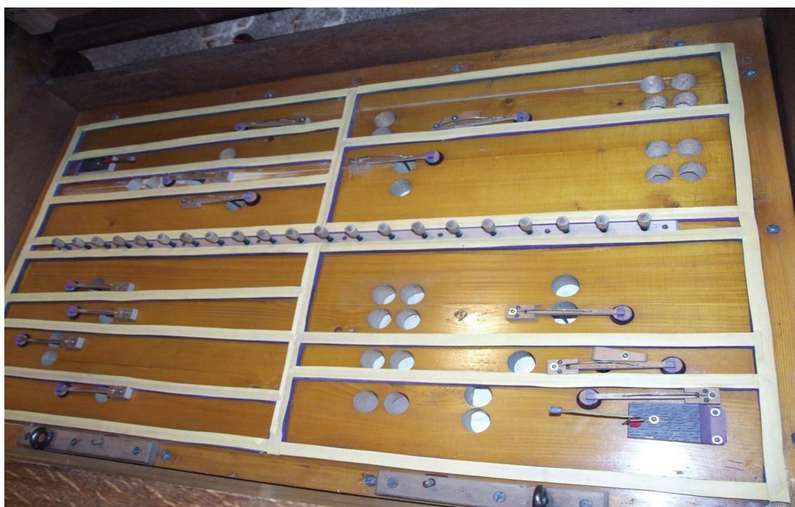
Fig. 11. – Table des registres avec les arrivées de vent dans les cases.
