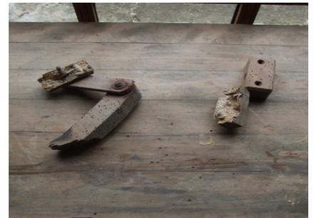
Fig. 8. – mécanisme de pompe verrouillé et cassé
