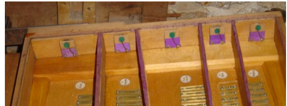
Fig. 7. – Vue de l'intérieur du sommier avec les soupapes de décharge en position latérale [2].
