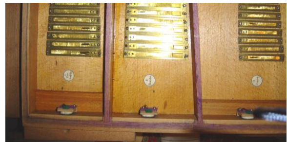
Fig. 8. – Détails des soupapes de décharge en position latérale [2].
